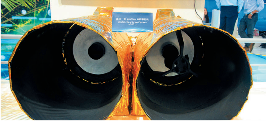
▲ Пара камер КА «Гаофэнь-1». Предположительно такие же камеры установлены и на КА JB-6
