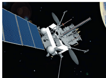
▲ Метеоспутник «Электро-Л» с радиаторами на контурных тепловых трубах
