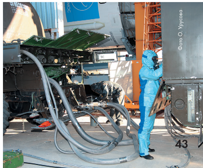
▼ На технологической заправочной площадке осуществляется заправка баков низкого давления разгонного блока «Бриз-М»
