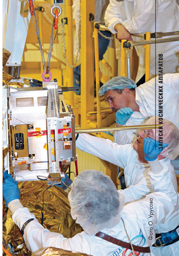
▲ Установка AISSat-2 на ферму «Фрегата-М»
