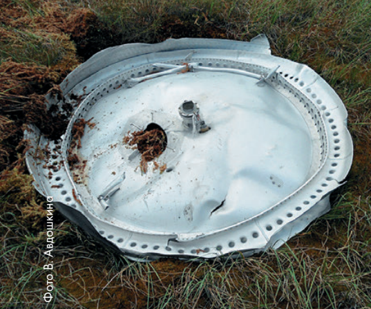
▲ Фрагмент днища бака окислителя центрального блока РН «Союз-2.1А», обнаруженный в районе падения №368
