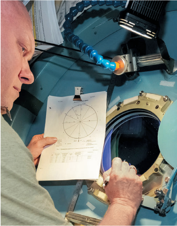
▲ Осмотр иллюминаторов модуля МИМ-2 проводит Олег Артемьев
