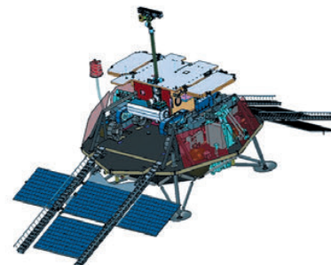
▲ Предварительные концепции десантного модуля и посадочной платформы ExoMars-2018
