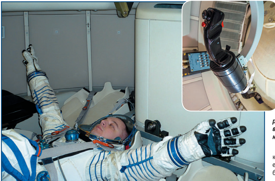
▲ Определение зон досягаемости экспериментальным методом. Справа сверху – ручка управления
