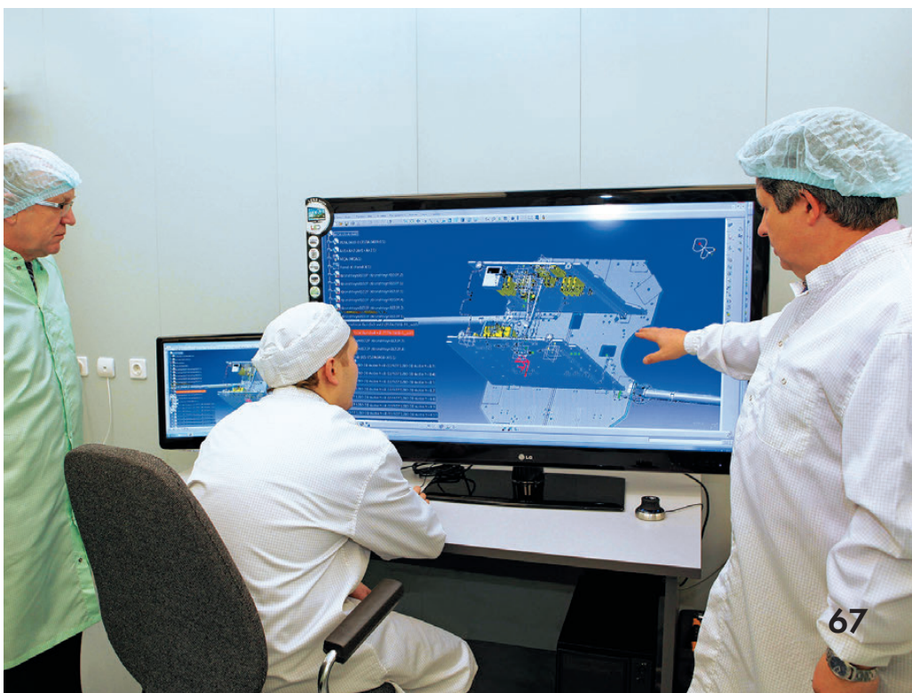
▼ На экране монитора – 3D-модель кабельной сети спутника «Луч-5А»
