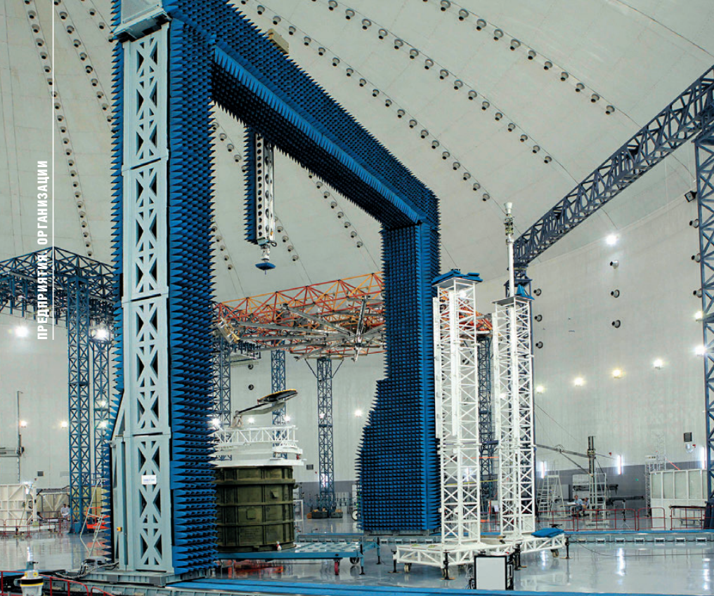
▲ Горизонтальный сканер в цехе антенно-фидерных устройств
