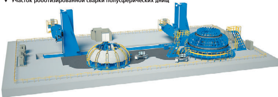
▼ Участок роботизированной сварки полусферических днищ
