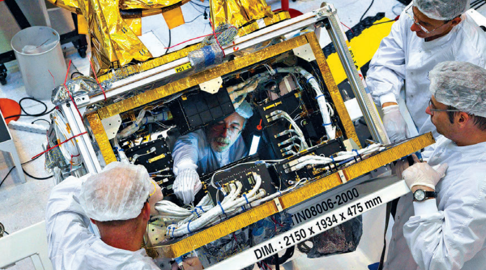
▲ Сборка модуля полезной нагрузки в Thales Alenia Space
