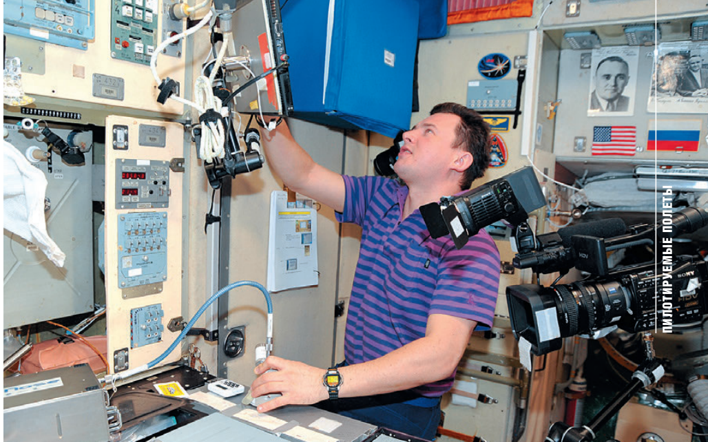
▲ Роман работает в «Звезде» с «электронным носом» – аппаратурой для регистрации малых примесей в атмосфере станции
