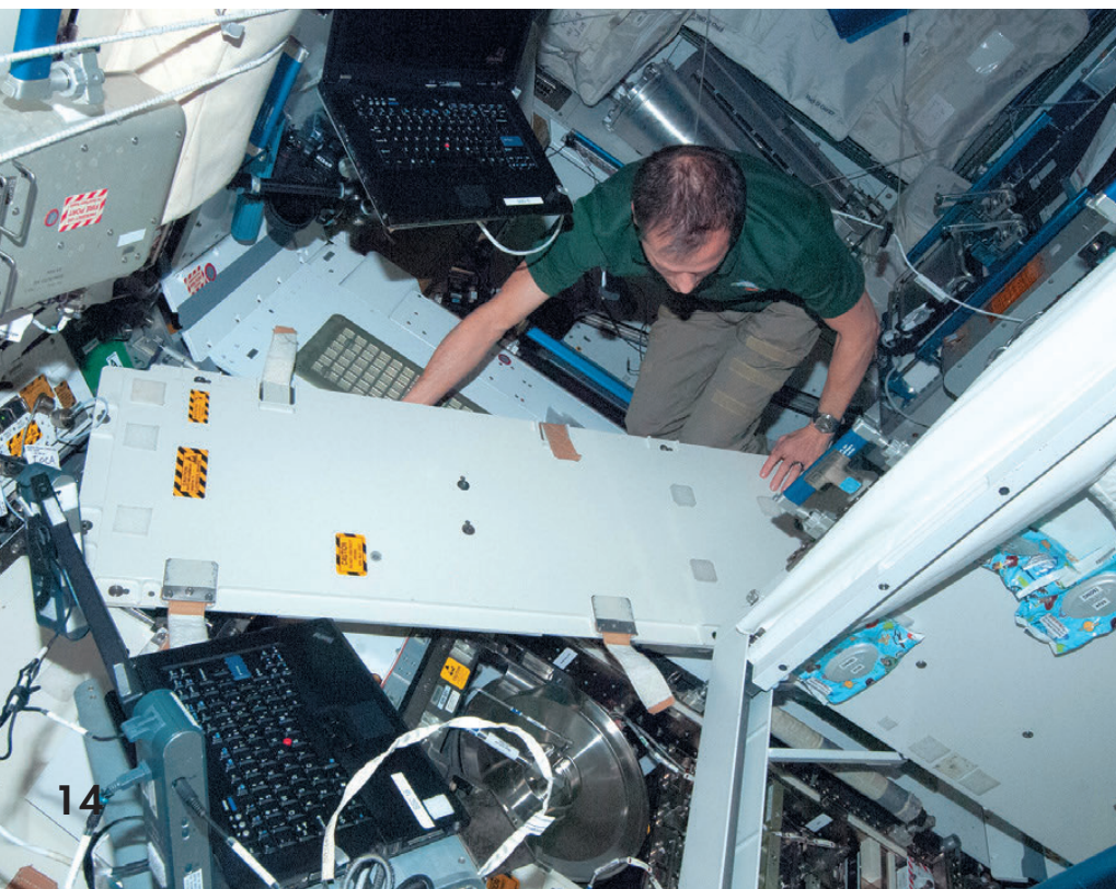
▼ Очередные работы с туалетом в модуле Node 3. Томас меняет бак с консервантом
