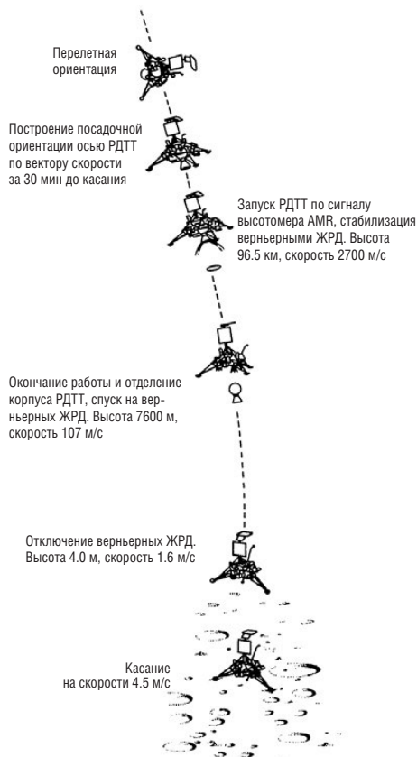
▲ Схема посадки КА Surveyor на Луну. Высоты, скорости и времена номинальные
