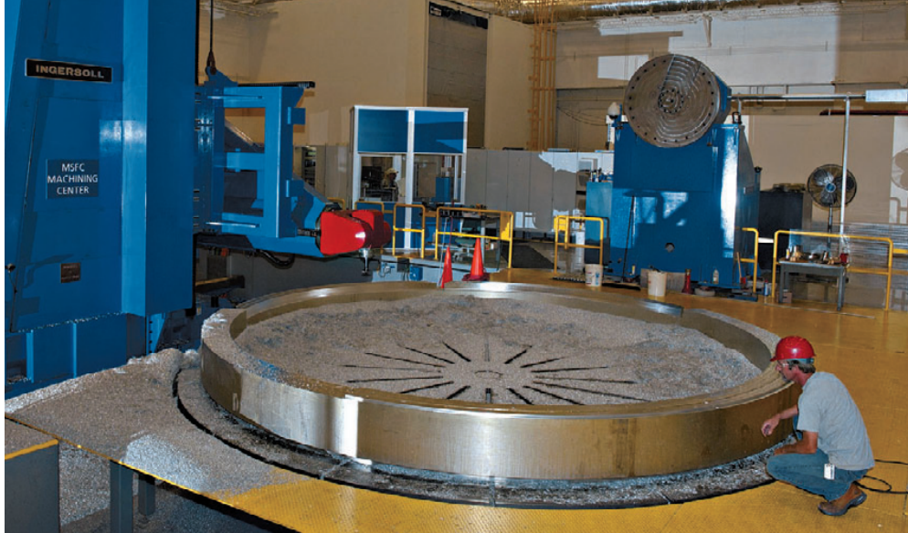
▲ На фрезерном станке в Центре Маршалла обрабатывают части адаптера для переходной системы «Ориона»
