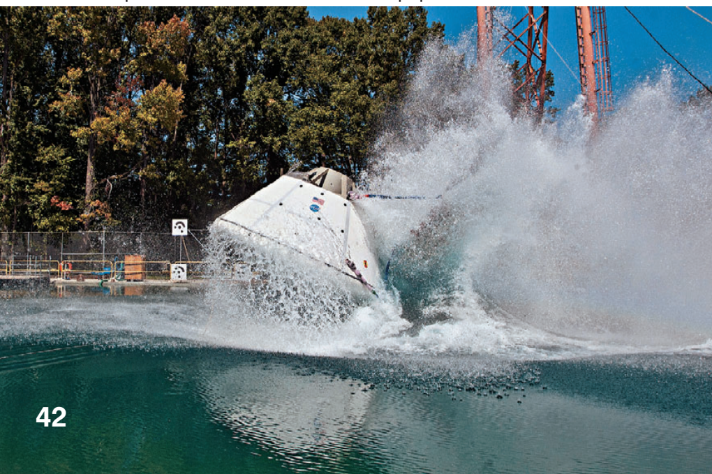
▼ Бросковые испытания макета MPCV в бассейне Центра Лэнгли
