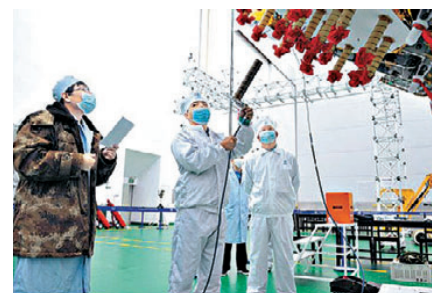
▲ Проверка антенного комплекса спутника китайской навигационной системы «Бэйдоу»
