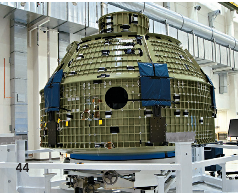
▼ Корпус командного модуля «Ориона» в Центре Кеннеди
