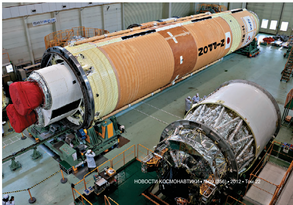
▼ Первая и вторая ступени носителя H-IIВ F3 в МИКе Космического центра Танэгасима
