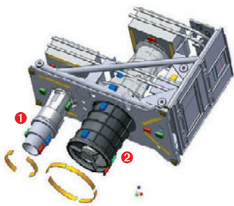
▲ Оптико-электронный модуль целевой аппаратуры состоит из многозональной (1) и панхроматической камеры (2)
