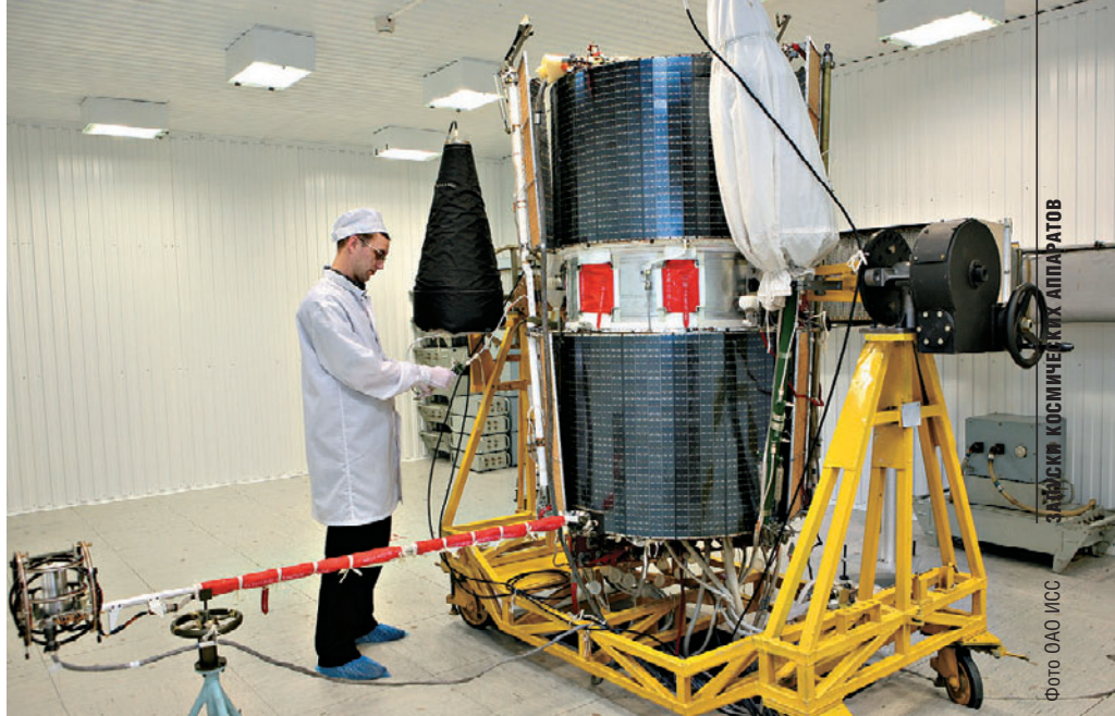
▲ «Гонец-М» в цехе электроиспытаний космических аппаратов
