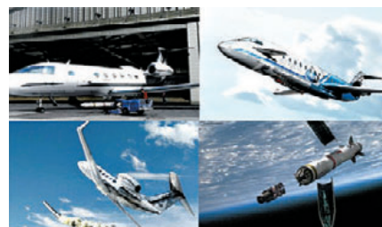
▲ Последовательность операций запуска спутника с помощью РН воздушного старта по проекту ALASA
