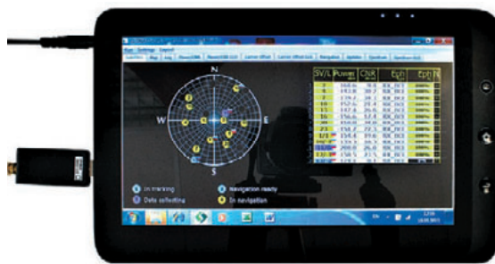
▲ С помощью USB-донгла (справа) и сверхчувствительного программного приемника можно пользоваться навигационными данными в закрытых помещениях
