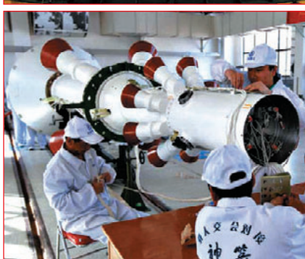
▲ Последней операцией при сборке РН CZ-2F является установка «башенки» системы аварийного спасения
