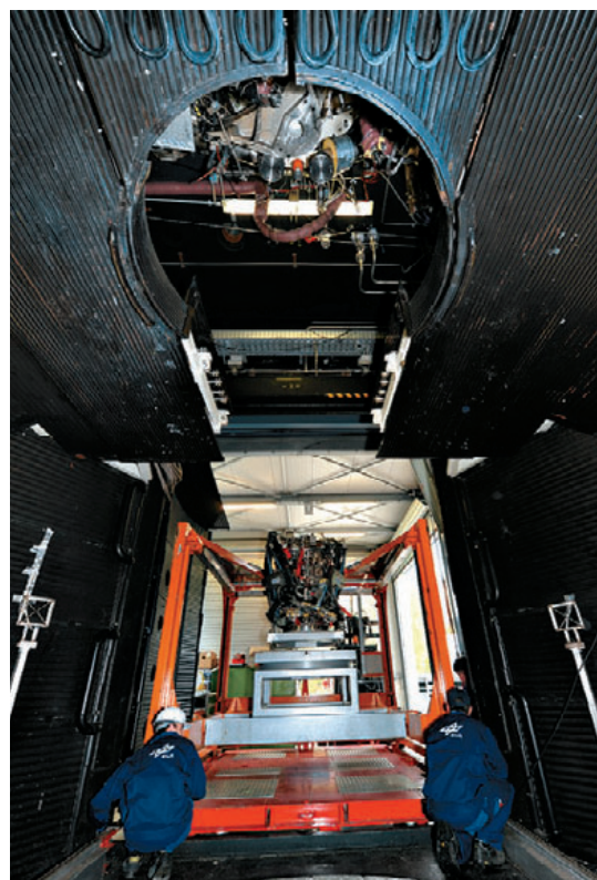
▼ Стенд в Лампольдсхаузене не позволяет испытать ступень ESC-B в полной комплектации
