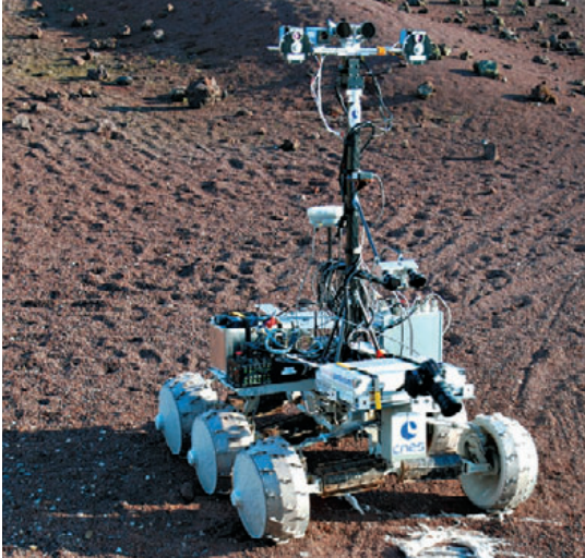
▲ Тем временем на ровере-прототипе испытываются приборы для будущей марсианской миссии – инструменты PanCam, WISDOM и CLUPI
