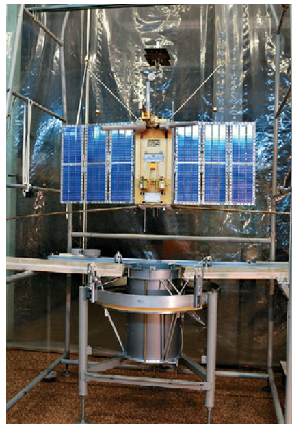
▲ Стенд вертикального обезвешивания для имитации выхода спутника «Чибис-М» из транспортно-пускового контейнера (цилиндр внизу, крепящийся на кольцо, имитирующем верхний люк «Прогресса-М»). СКБ КП ИКИ РАН (г. Таруса)
