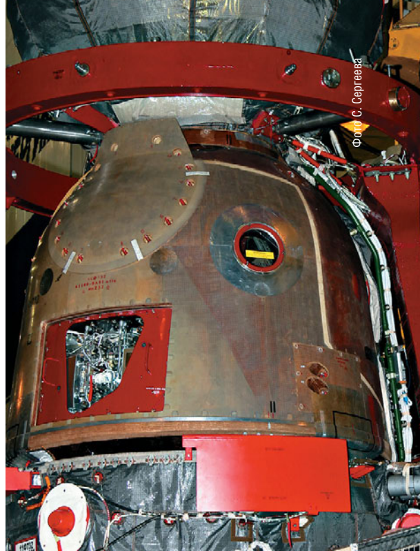
▲ Спускаемый аппарат «Союза», где хорошо видно расположение контейнера пневмогидроагрегата
