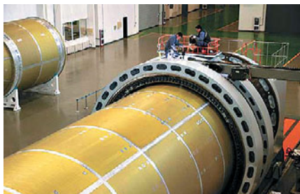
▼ Сварка 5-метрового водородного бака
