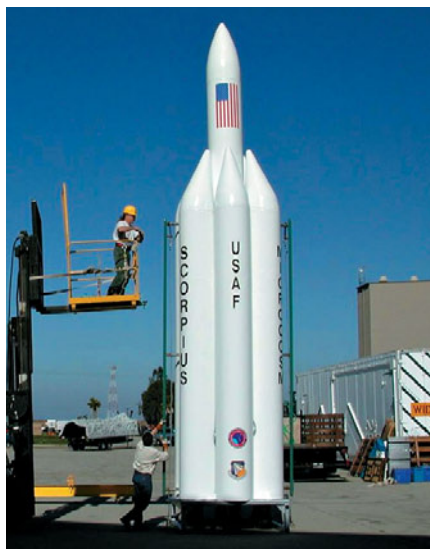
▲ ПН Sprite Mini Lift фирмы Microcosm сможет вывести на орбиту до 100 кг
