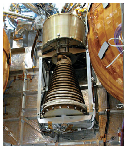
▲ Посадочная ступень MSL (вверху) и катушка с тросом, на котором будет опускаться ровер
