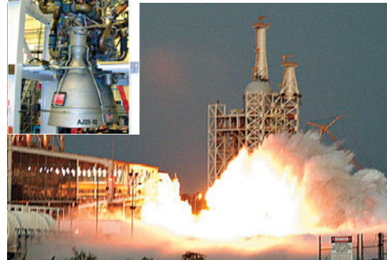
▼ Приемоочные испытания двигателя AJ-26 на стенде Центра Стенниса NASA
