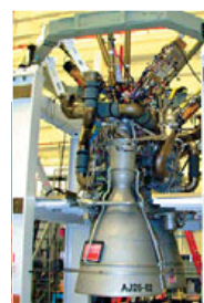
▼ Приемоочные испытания двигателя AJ-26 на стенде Центра Стенниса NASA
