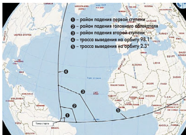
▲ Трассы выведения РН «Циклон-4» с космодрома Алкантара на орбиты наклонением 2,3° (азимут пуска – 86°) и 98,1° (азимут пуска – 17° с последующим разворотом к западу на активном участке траектории)
