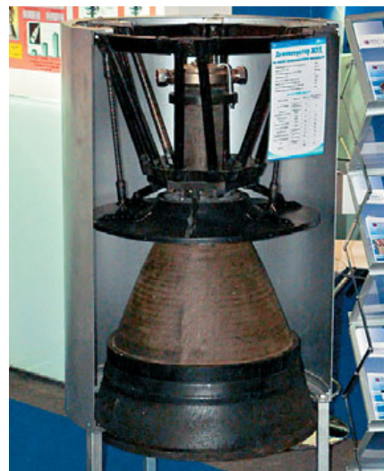
▲ Демонстратор ЖРД с раздвижным соплом из УУКМ
