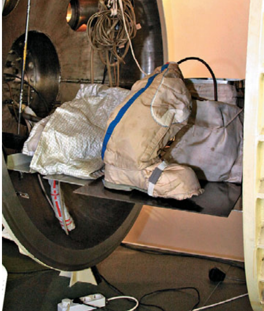
▲ Подогреваемая стелька скафандра «Орлан-МКС» испытывается в барокамере БК-5
