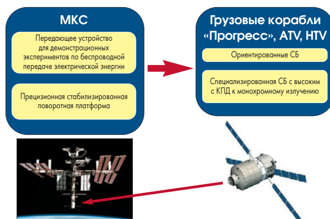
▲ Рис. 2. Демонстрационные эксперименты по беспроводной передаче электрической энергии в космосе
