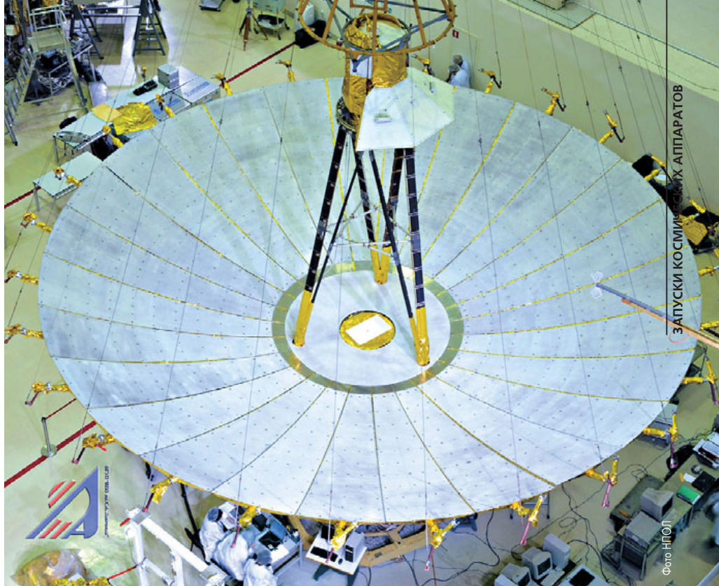
▲ Уникальная 10-метровая антенна «Радиоастрона»
