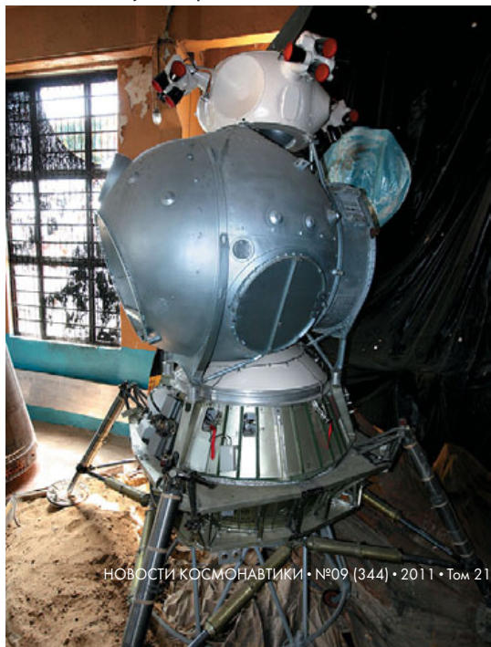
▼ Лунный корабль 11Ф94 для динамических испытаний
