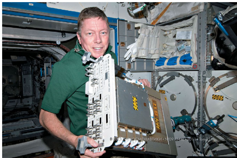
▼ Майкл Фоссум заменил блок электроники морозильника MELFI-3 в модуле Kibo
