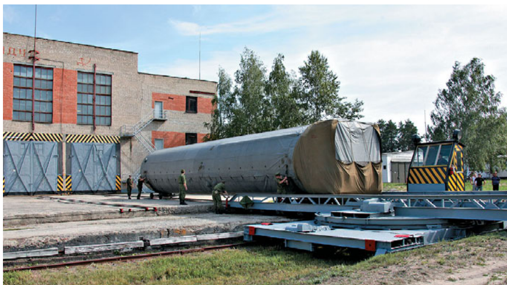
▲ Перевозка ступени РН из цеха обслуживания на трансбордерную тележку
