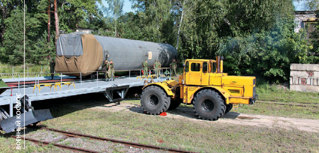
▲ Подцепка трактора для транспортировки ступени
