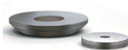
▲ Рентгеновские зеркала с многослойным покрытием, изготовленные в Институте физики микроструктур РАН для космических телескопов ФИАН на спутнике «Коронас-Фотон»
