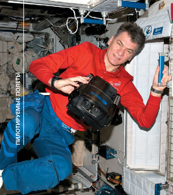
▲ Бортинженер Паоло Неспולי работает с бинокулярной стереокамерой ERB2 в модуле Harmony. Камера ERB2 является результатом модернизации камеры ERB1, эксплуатируемой на станции с июня 2006 г. Новый вариант имеет повышенную чувствительность в условиях слабого освещения, а его разрешение 1280x720 точек дает совместимость с коммерческим стандартом HDTV. С помощью ERB2 можно проводить прямые репортажи через имеющуюся на станции высокоскоростную радиолинию HRDL. Результаты съемок предполагается использовать для пропаганды космических экспериментов в Европейском центре виртуальной реальности Erasmus
