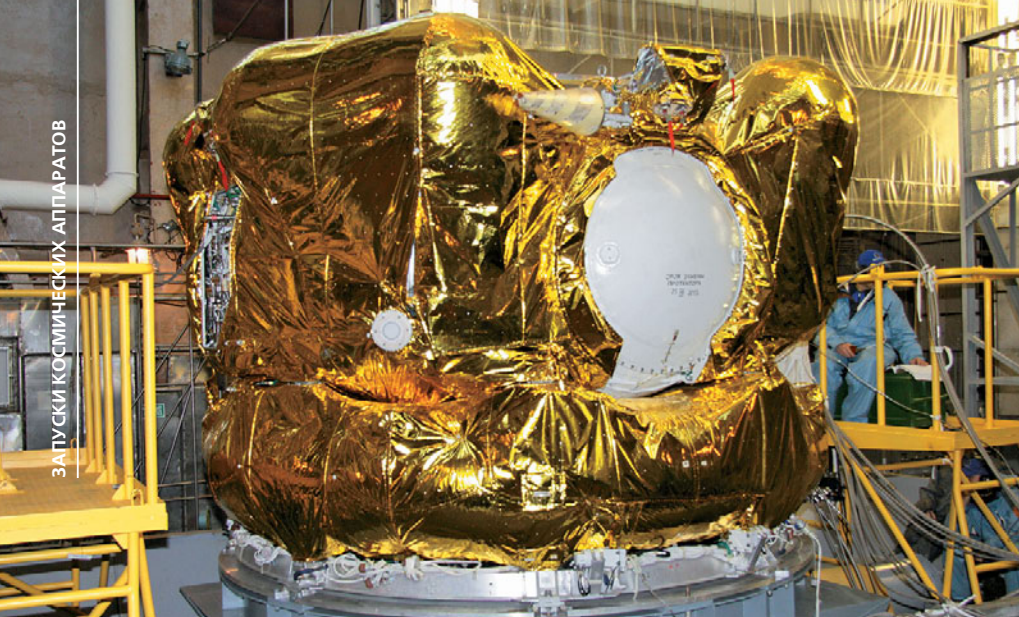
▲ Разгонный блок «Фрегат-СБ»: габаритные размеры – высота 2.3 м, диаметр 3.44 м; масса при максимальной заправке – до 11 600 кг; конечная масса сбрасываемого блока баков – 375 кг; конечная масса РБ – 950 кг
