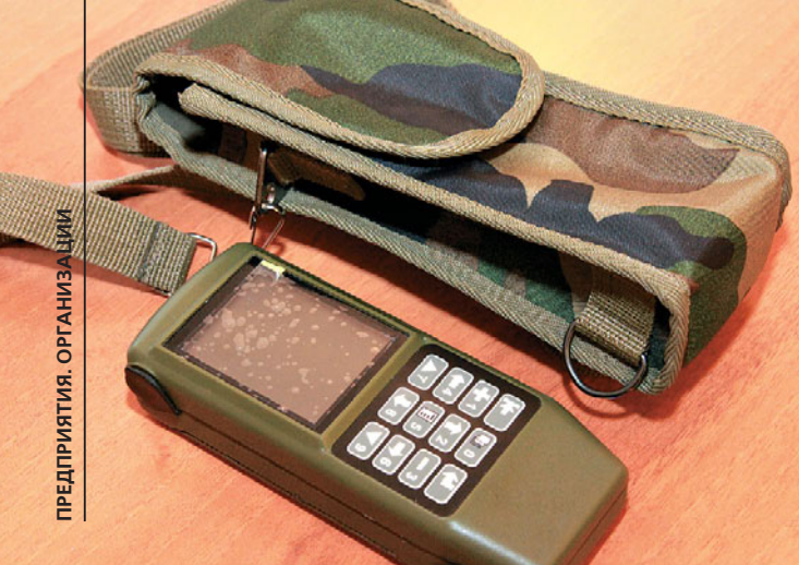
▲ Малогабаритная навигационная аппаратура потребителя КИС ГЛОНАСС/GPS «Грот-М» для определения координат, путевой скорости и курса
