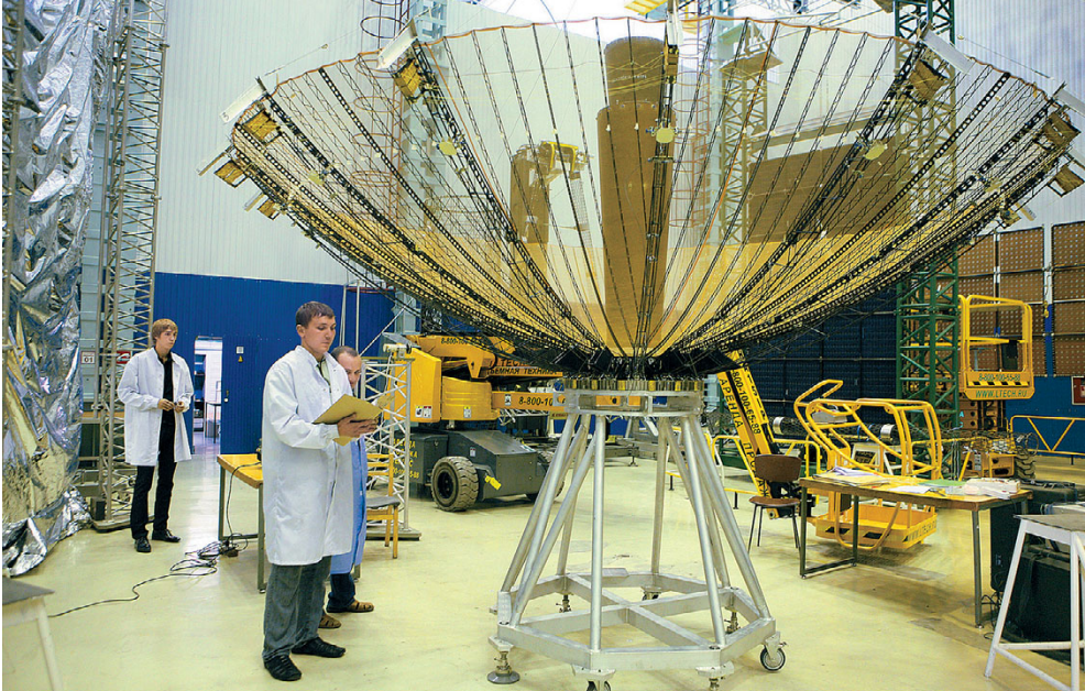
▲ Испытания рефлектора антенны КА «Луч-5А»
