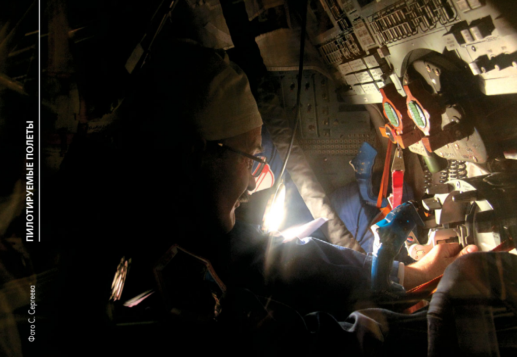
▲ Примерка корабля в МИКе происходит при свете ручных фонарей
