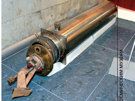
▲ Мазер 5-сантиметрового диапазона для приемных систем антенных устройств П-2500
