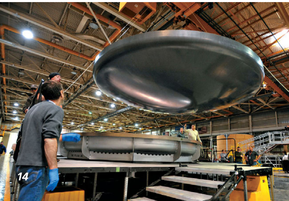
▼ Композитный теплозащитный экран для «Ориона» изготовлен компанией Lockheed Martin
