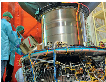
▲ AISSat-1 устанавливают на адаптер
