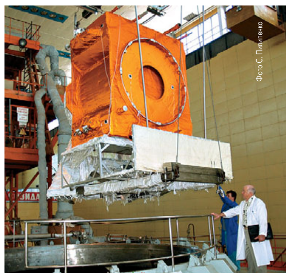
▲ Макет КА KazSat-2 загружают в вакуумную камеру ВК600/300 для испытаний
