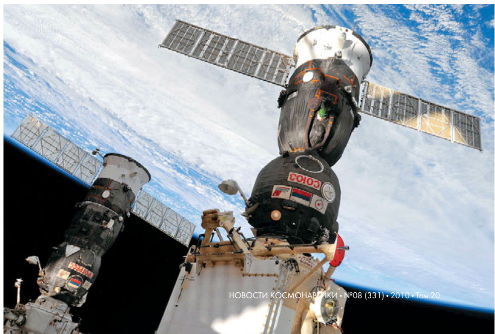
▼ «Союз ТМА-19» (на переднем плане) пристыкован к «Рассвету», «Прогресс М-05М» – к «Пирсу»
