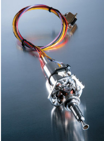
▲ Микродвигатель HPGP компании ECAPS
