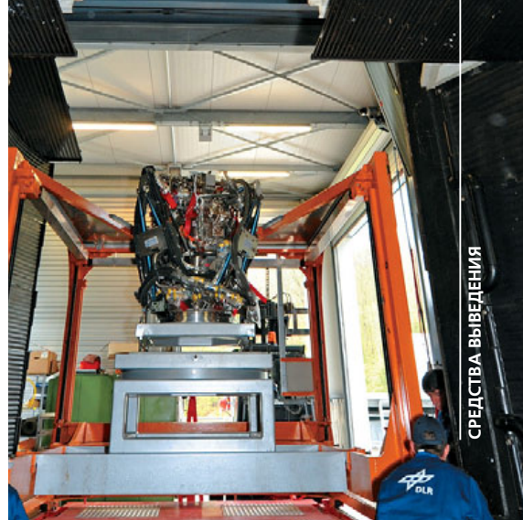
▲ Установка ЖРД Vinci в вакуумную камеру для испытаний на стенде P4 в Лампольдсхаузене
