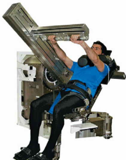
▲ Стойка MARES поможет более полно оценить влияние невесомости на опорно-двигательную и мышечную систему космонавтов
