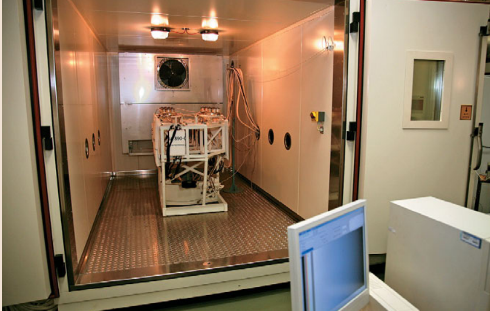
▲ Бортовой источник навигационного сигнала КА системы ГЛОНАСС в термокамере
