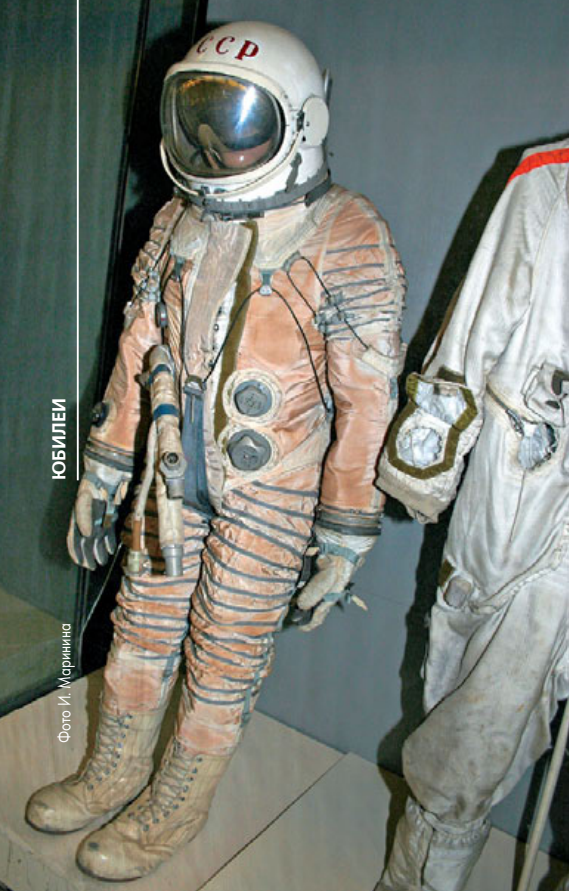
▲ Скафандр «Беркут» включал две герметичные оболочки и одну силовую, а также верхнюю одежду с экранно-вакуумной теплоизоляцией
