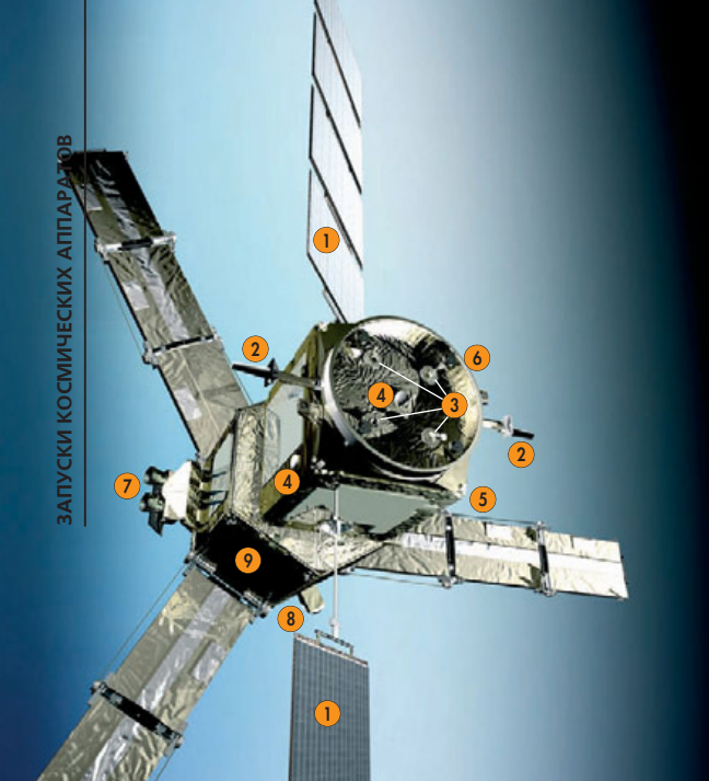
▲ Конструкция космического аппарата SMOS: 1 – панели солнечных батарей; 2 – антенны S-диапазона; 3 – гидразиновые ЖРД; 4 – антенна GPS-приемника; 5 – грубые солнечные датчики (по одному на каждом углу); 6 – адаптер стыковки с носителем; 7 – звездный датчик; 8 – антенна X-диапазона; 9 – несущая конструкция ПН; 10 – приемные элементы (LICEF, всего 69) антенны радиометра; 11 – корневой узел поворота с регулятором скорости раскрытия; 12 – промежуточный узел поворота с пружинным приводом; 13 – тросы синхронизации раскрытия трех секций антенны; 14 – спутниковая платформа Proteus. На врезке – конструкция приемных элементов антенны LICEF: а – углеволоконная конструкция; b – поверхность антенны; c – питающие диски; d – зазор; e и g – алюминиевые проставки; f – волноводы (многослойные микрополосковые линии)
