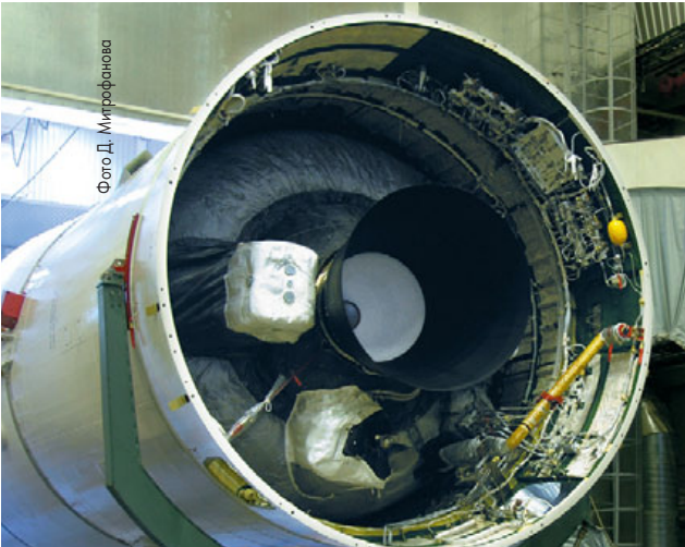
▲ Разгонный блок ДМ-SLB №4Л: вид со стороны переходной фермы и маршевого двигателя
