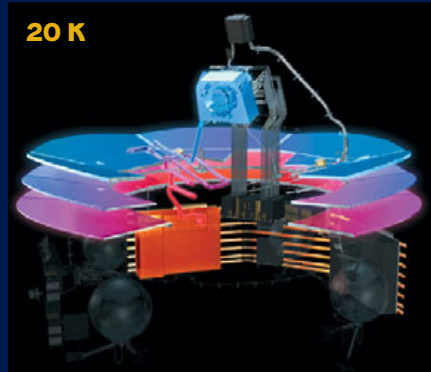
▲ Схемы последовательного охлаждения научной аппаратуры КА Planck до 20 К (внизу), 4 К (в середине) и 0.1 К (вверху). Начальное радиационное охлаждение до 45 К обеспечивают три экрана конической формы. Сорбционный кулер (один из двух компрессоров выделен оранжевым) обеспечивает охлаждение детекторов LFI до 20 К и предварительное охлаждение детекторов HFI до 18 К. Кулер Джоуля–Томпсона на гелии-4 (один из двух компрессоров выделен желтым) обеспечивает дальнейшее охлаждение до 4 К. На последнем этапе используется охлаждение за счет растворения гелия-3 в гелии-4 внутри блока фокальной плоскости HFI (выделен голубым). Запас гелия-4 хранится в трех, а гелия-3 – в одном шар-баллоне
