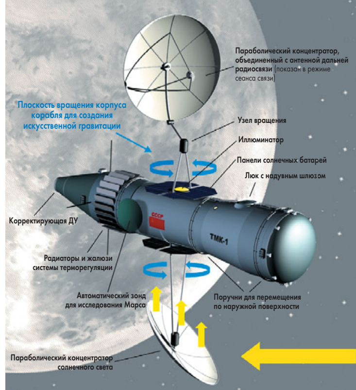
▲ Наружные элементы бортовых систем ТМК 1962 г. Вариант облета Марса с использованием разгонных ЖРД
