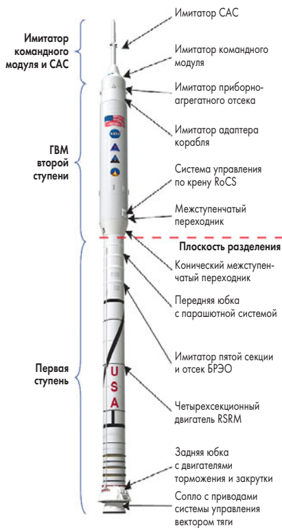
▲ Конструкция ракеты Ares I-X
