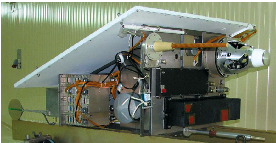
▲ Научная аппаратура МКА «Университетский – Татьяна-2» состоит из телескопа «Т» и спектрометра «С» в составе прибора МТЕЛ (нижний бокс с тремя окнами), детектора флуктуаций потока заряженной компоненты «ФЗК» и детектора УФ- и красного излучения «ДУ-ФиК» (бокс над прибором МТЕЛ). Показана сторона МКА, направленная к Земле
