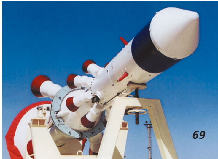
▼ По функциональным особенностям САС китайского корабля «Шэньчжоу» напоминает аналогичную систему корабля «Союз-ТМА»
