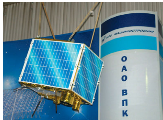
▲ Аппарат ДЗЗ, разработанный НПО машиностроения на базе микроспутника «Бауманец»
