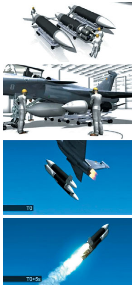
▲ Проект воздушного старта увеличенной грузоподъемности (до 150 кг) фирмы Dassault Aviation
