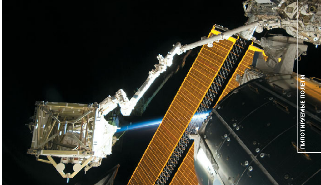
▲ Транспортировка секции S6 к месту монтажа
