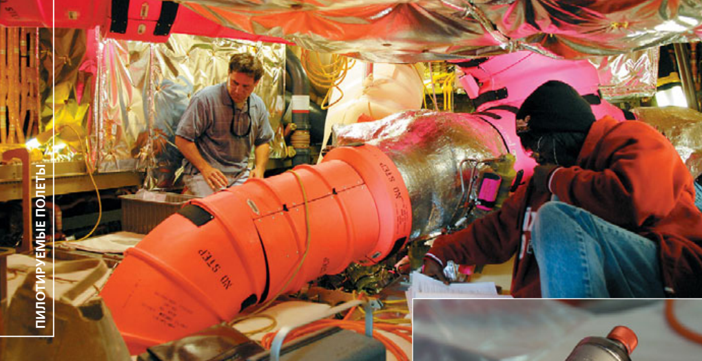
▲ Техники меняют «проблемные» клапаны FCV в двигательной установке «Дискавери»
