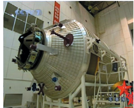
▲ Космическая лаборатория «Тяньгун-1» будет оснащена андрогинным стыковочным узлом
