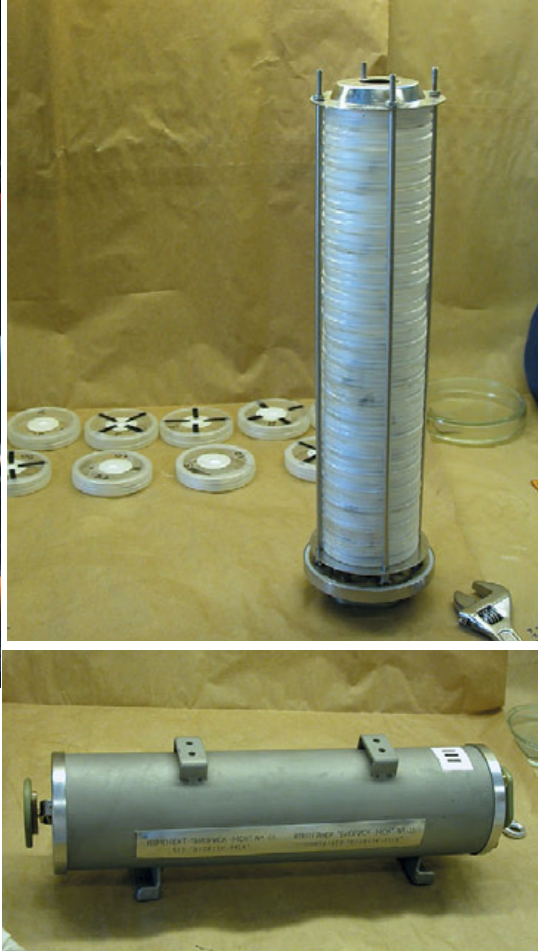
▲ Аппаратура эксперимента «Биориск»: герметичный контейнер (внизу) и сборка из чашек Петри
