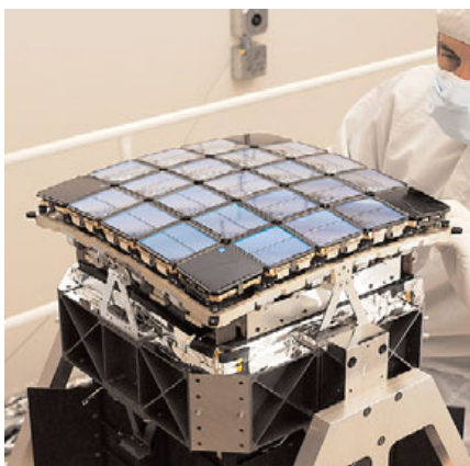
▲ Сборка ПЗС-матриц телескопа Kepler
