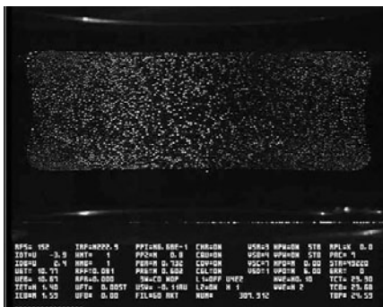
▲ Видеоизображение плазменно-пылевой структуры с монодисперсными частицами диаметром 3,4 мкм, полученное камерой общего вида. Давление аргона 60 Па
