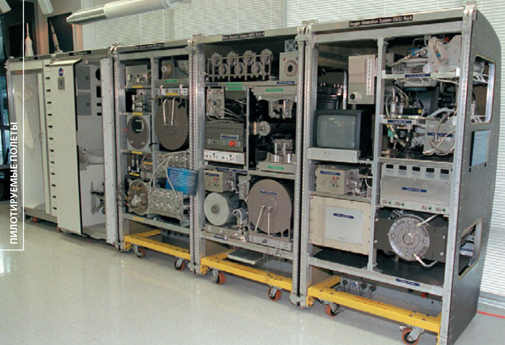
▲ Макеты стоек системы жизнеобеспечения (слева направо): душевая, туалет, две стойки WRS и OGS
