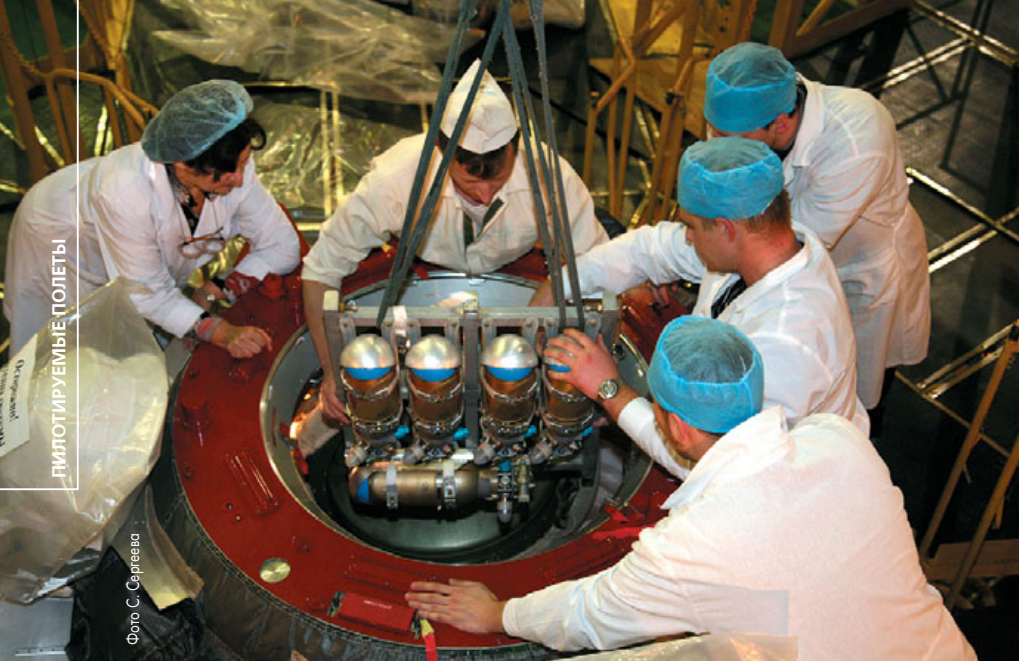
▲ В «Прогресс» загружают укладку из пяти кислородных баллонов БК-3М
