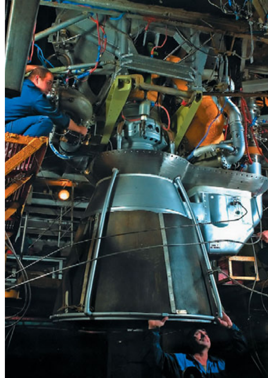
▲ Монтаж двигателя на испытательный стенд
