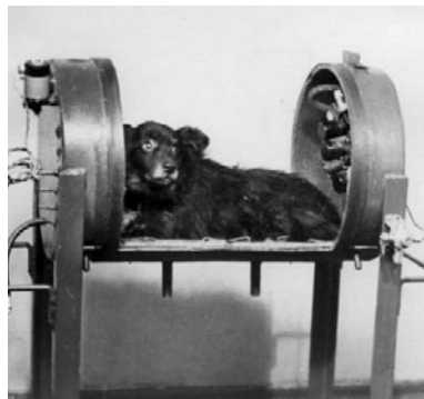
▲ Установка для исследования взрывной декомпрессии
