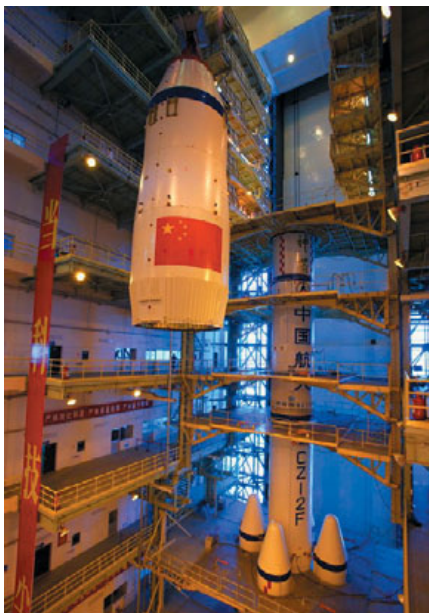
▲ Установка головного блока на носитель. Фото CMSE
