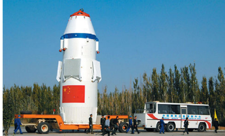
▲ Головной блок с кораблем «Шэньчжоу-7» перевозится в здание вертикальной сборки. Фото CMSE
