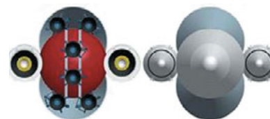
▲ Новое расположение двигателей RS-68 и последовавшие за этим изменения хвостового отсека PH Ares V
