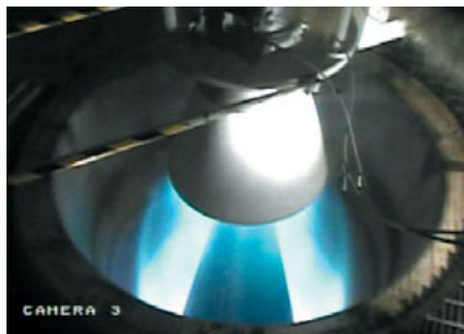
▲ Испытания двигателя RS-18 на жидком кислороде и жидком метане
