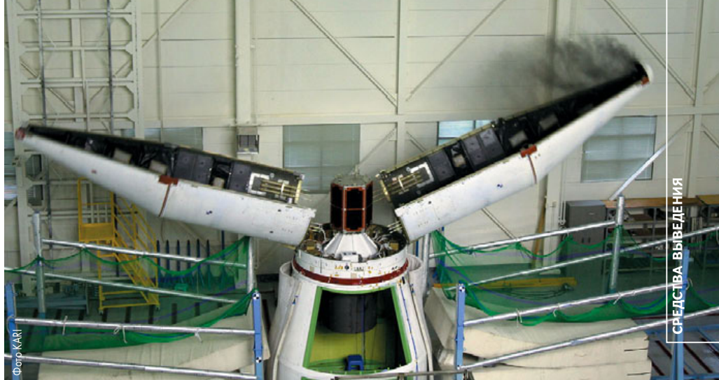
▲ Испытания системы сброса створок головного обтекателя ракеты KSLV-I
