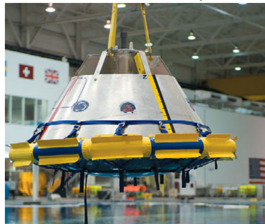
▲ Испытания модели «Ориона» в бассейне
