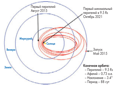
▲ Траектория перелета AMC Solar Probe Plus
