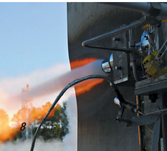
▼ Испытания газогенератора двигателя J-2X
