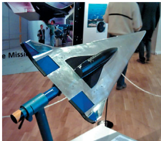
▲ Маломасштабная продувочная модель системы Saenger-2 для исследования сил и моментов, возникающих в полете
