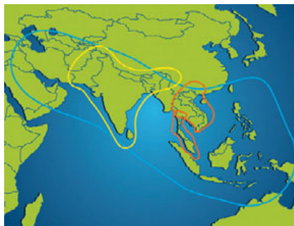
▲ Зона покрытия ретрансляторов КА Protostar-1. Голубым цветом показана зона С-диапазона, желтым и оранжевым – Ku-диапазона
