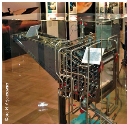
▲ Стендовый образец сопла прямоточного двигателя самолета-разгонщика
