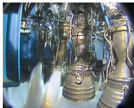
▲ Огневые испытания связи из трех ЖРД носителя Falcon 9
