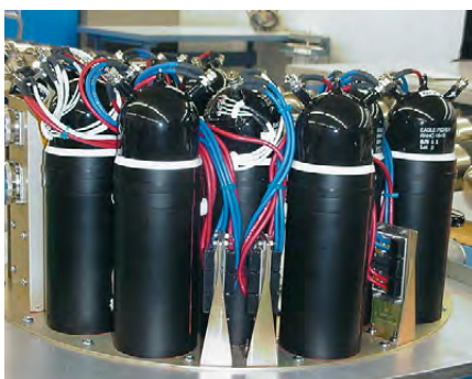
▲ Никель-водородная аккумуляторная батарея КА C/NOFS произведена компанией EaglePicher Technologies LLC и состоит из 11 элементов
