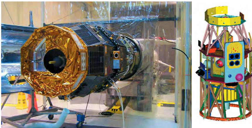
▲ KA C/NOFS пристыкован к носителю и готовится к запуску. Сравнивая и анализируя фотографии спутника и его рисунки (в заголовке статьи), можно сделать вывод, что его нижняя часть с панелями СБ – сдвижная
