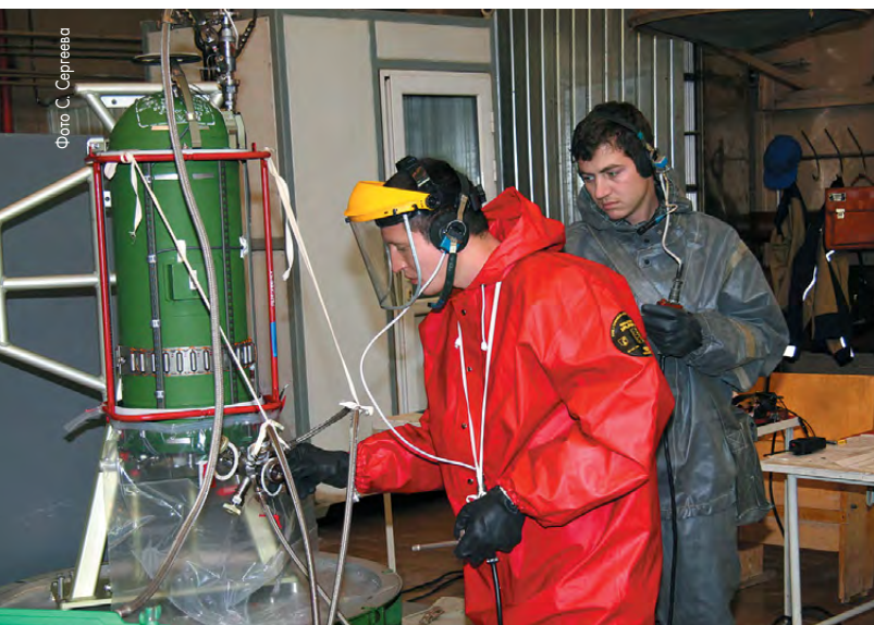
▲ Заправка гидразином блока хранения и подачи рабочего тела ДУ
