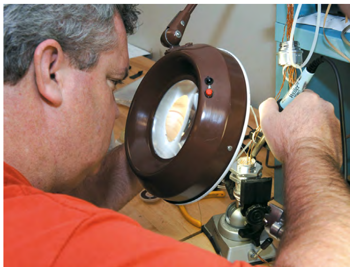
▲ Сотрудник United Launch Alliance Боб Арп ликвидирует саму возможность утраты электрического контакта в разьеме на внешнем баке шаттла: припаем – полетим
