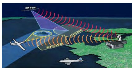
▲ Концепция применения системы «Полярный эпсилон» для мониторинга Арктики с помощью воздушно-космических средств. На рисунке указаны загоризонтные РЛС, КА Radarsat-2, БПЛА и патрульные самолеты базовой авиации
