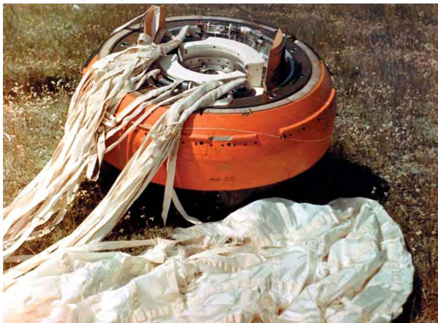
▼ Спускаемый аппарат «Венеры-4» после бросковых испытаний
