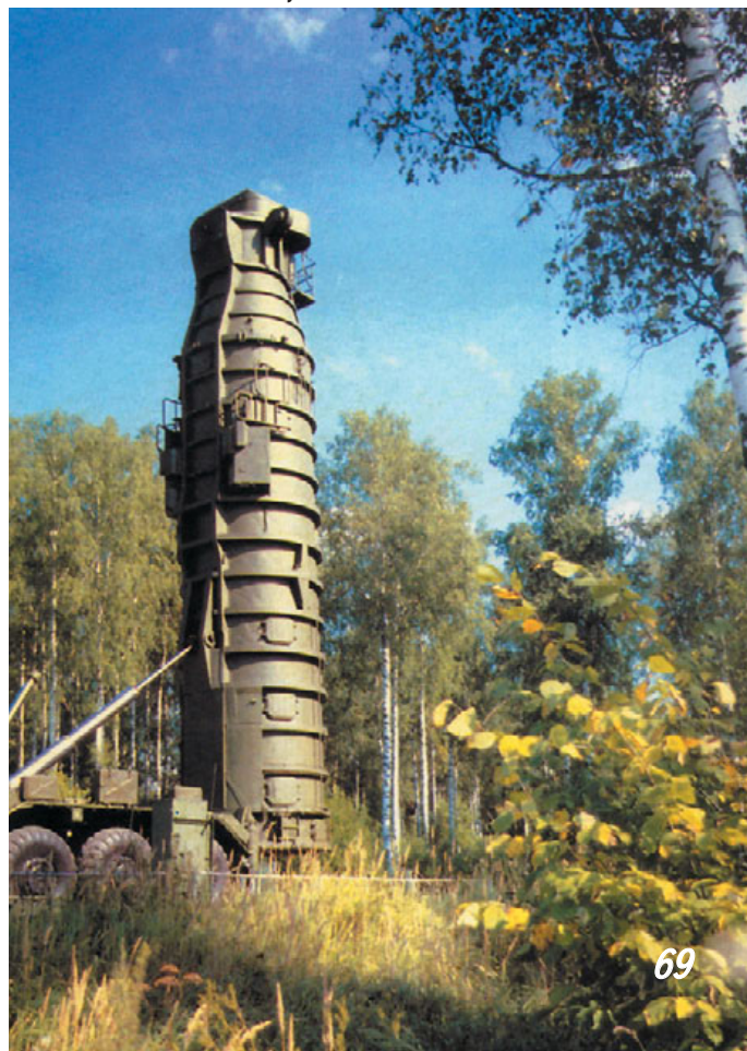
▼ Установка МБР РТ-2П в шахту
