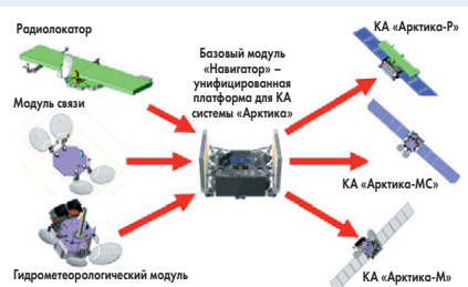
▲ Рис. 2. Принципы построения КА серии «Арктика»
