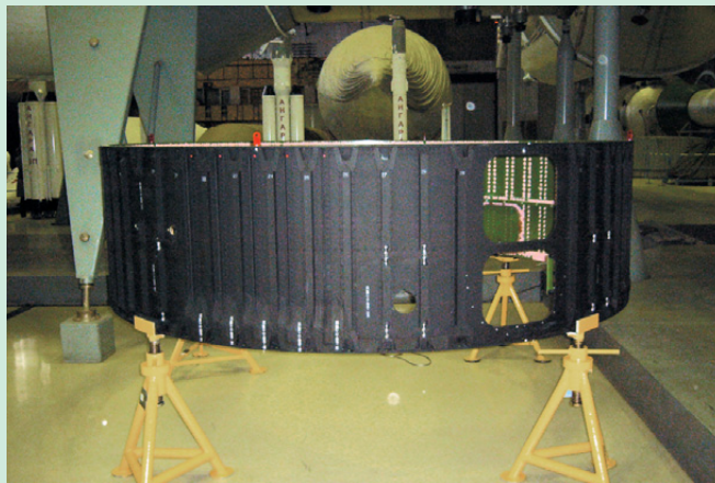
▼ Слева – бак горючего; справа – межбачковый отсек первой ступени корейского носителя KSLV-1 в Центре Хруничева
