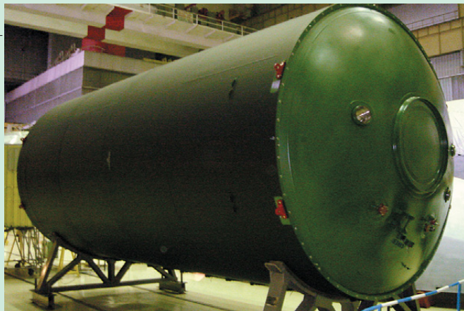
▼ Слева – бак горючего; справа – межбачковый отсек первой ступени корейского носителя KSLV-1 в Центре Хруничева
