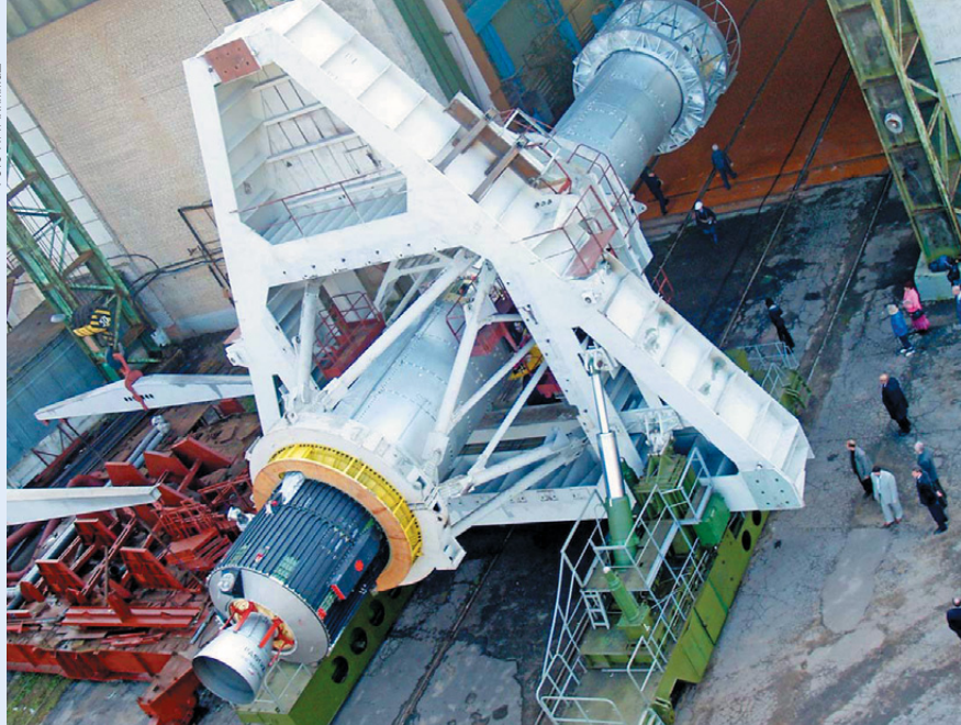
▲ Макет УРМ-1 в корсете на установщике вывозят из МИКа для примерки на стенд НИИХиммаш
