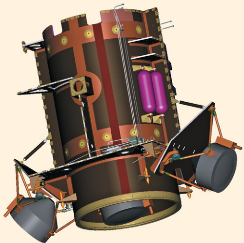
▲ Силовая основа корпуса AMC и разрез, на котором видны баки ксенона и гидразина
