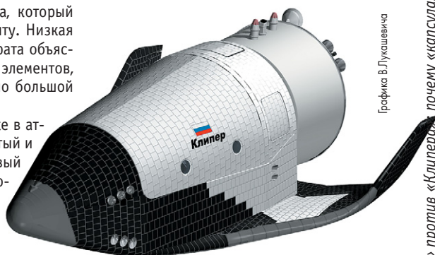
▲ Крылатый корабль с горизонтальной планирующей посадкой на ВПП. Малые перегрузки при спуске, большие возможности по маневрированию
