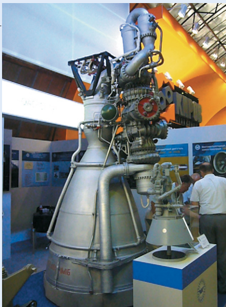
◀ Частый гость московских выставок НК-33 и его «младший брат» НК-33-1 с выдвижным насадком
