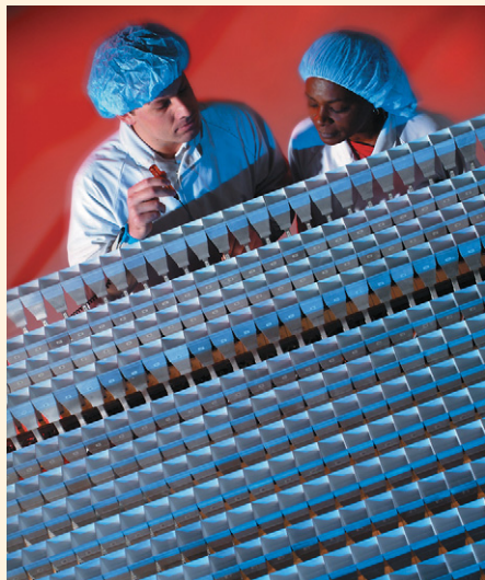
▲ Фазированная передающая антенна спутника SpaceWay
