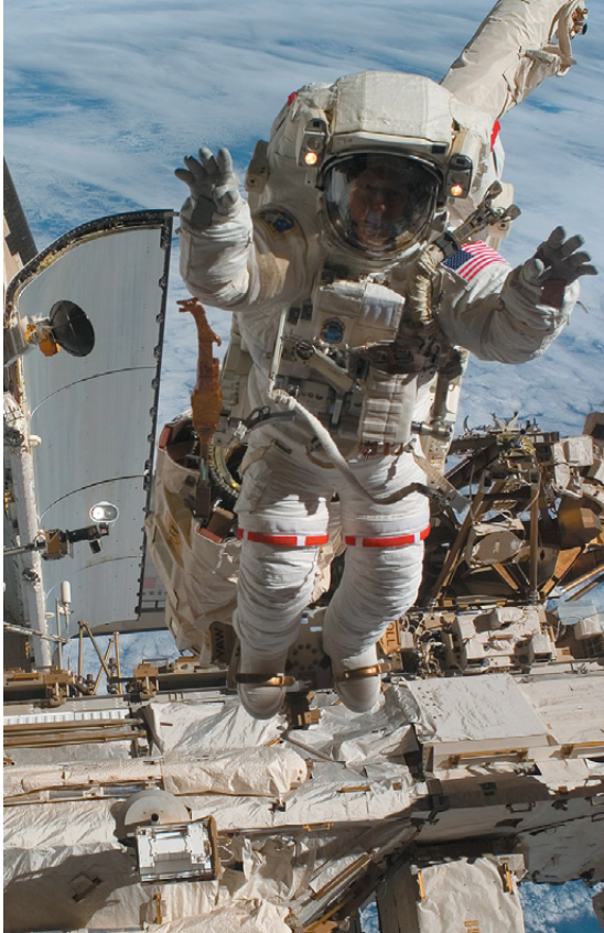
▲ Астронавт Патрик Форрестер зафиксирован на манипуляторе станции и готов к складыванию солнечных батарей 2В на секции Р6
