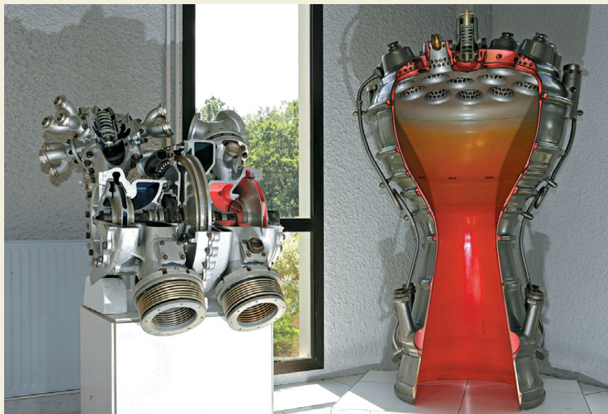
▲ Турбонасосный агрегат (ТНА) и камера сгорания двигателя первой дальней баллистической ракеты А-4 (V-2). Немецкий двигатель совсем не случайно находится в музее Снепта
