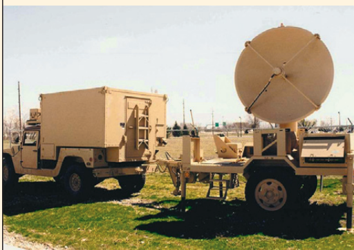
▲ Малогабаритная станция MIST будет использоваться для передачи и приема данных со спутника TacSat-2
