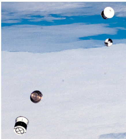
▲ Процесс запуска спутников ANDE. Сверху вниз: верхняя часть контейнера, спутник ANDE MAA, проставка, нижняя часть контейнера со спутником FCal внутри
