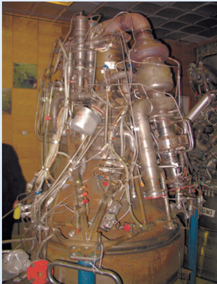
▲ Стендовый вариант КВД-1 для испытаний на смеси жидкий кислород – метан
