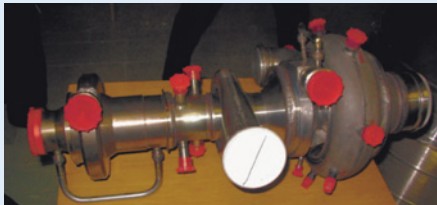
▲ Модифицированный ТНА двигателя КВД-1 для работы на метане
