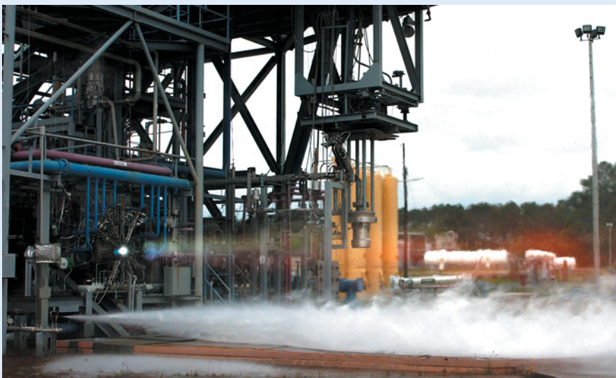
▲ Испытания масштабной модели инжектора двигателя J-2X
