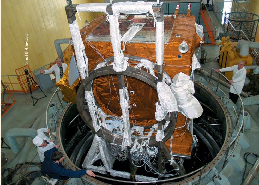
▲ Термовакuumные испытания «КазСат» проходил в НИИ химмаш в середине марта 2006 г.
