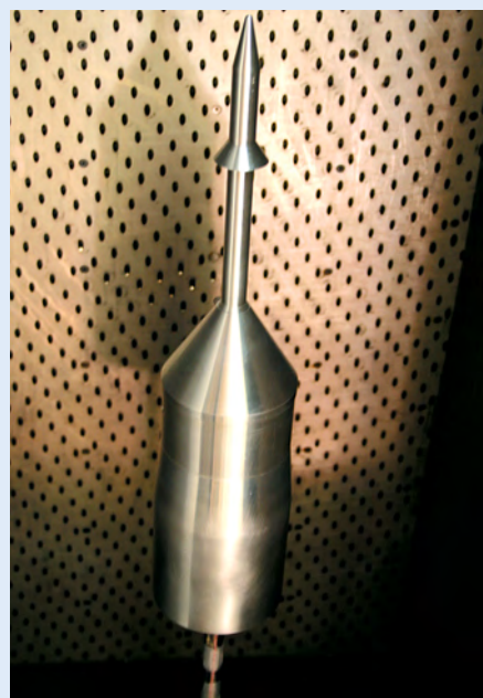
▲ Макет головной части PH Ares I для продувок
