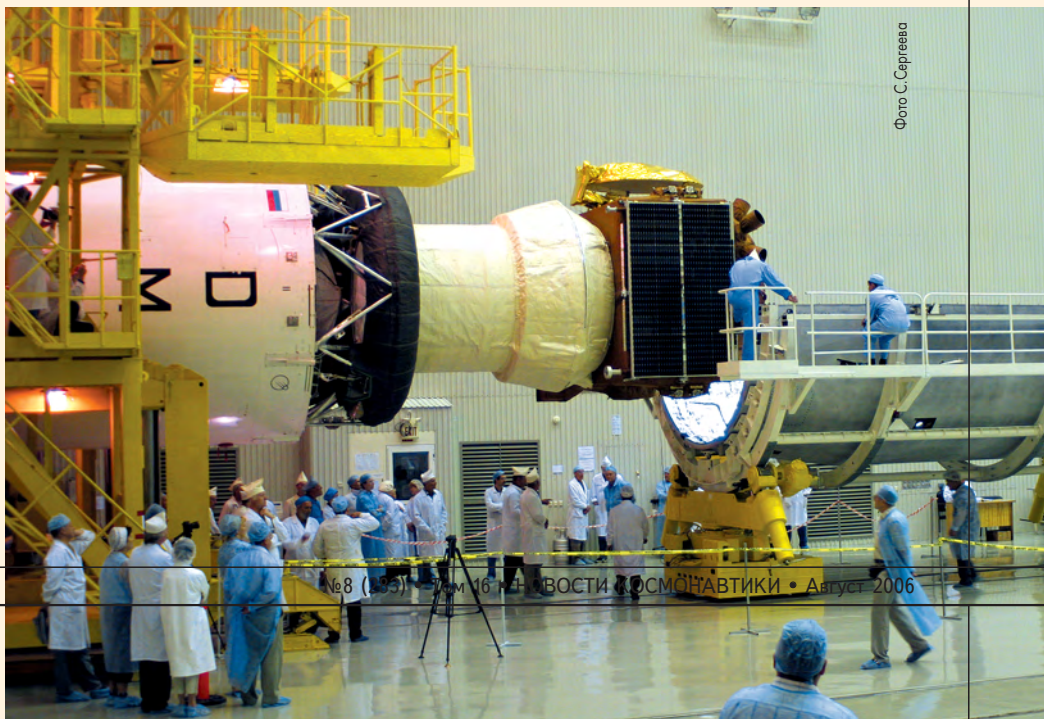
▼ Завершение сборки КГЧ: установка створок обтекателя
