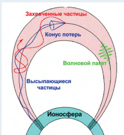
▲ Магнитосферный циклотронный мазер: Активное вещество: энергичные электроны ( W_e > 5 кэВ), протоны ( W_p > 10 кэВ). Электродинамическая система: магнитная силовая трубка с холодной плазмой; зеркала – сопряженные области ионосферы. Рабочие моды: свистовые и ионно-циклотронные волны
