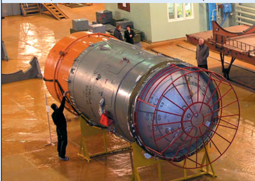
▲ Блок «И» для «холодных» испытаний
