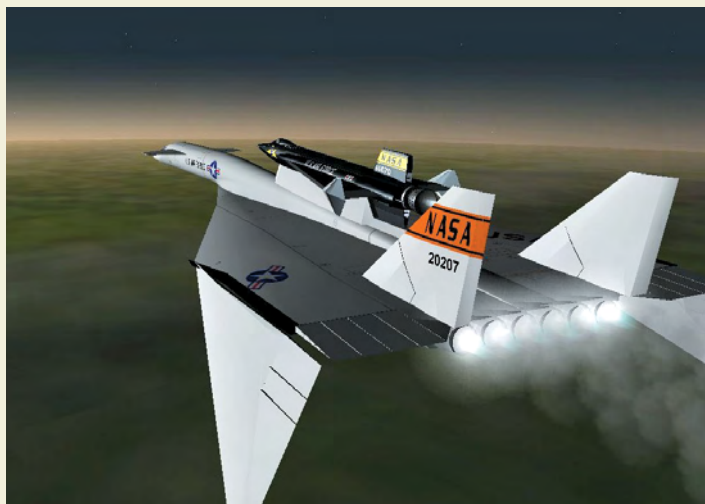
▲ Вариант запуска модификации ракетоплана X-15 с самолета-носителя B-70 реально прорабатывался
