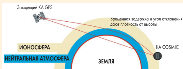
▲ Рис.1. Схема измерений по методу радиопросвечивания атмосферы сигналами спутников системы GPS
