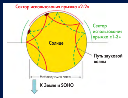
▲ Схема регистрации звуковых волн, отраженных от пятен на невидимой стороне Солнца по типу «2-2» и «1-3»
