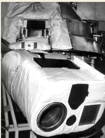
▲ Платформа АСП-Г в раскрытом положении, в которое она приводилась перед исследованием кометы. В верхней части снимка видны фрагменты противопылевой защиты служебного модуля. Слева противопылевая защита покрыта ЭВТИ, справа – нет
