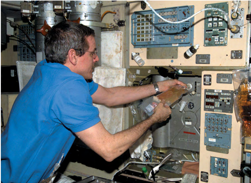
▲ Кипяточек на станции наливают из «титана», официально называемого «блок распределения и подогрева воды модернизированный» (БРП-М)
