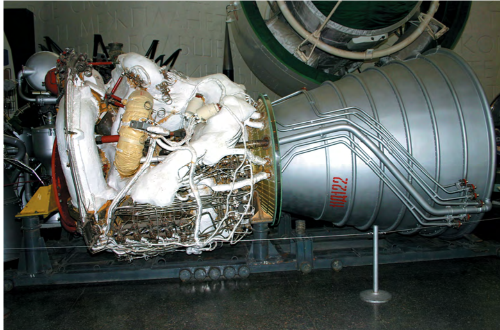
▲ Двигатель коррекции и сближения С5.62 для корабля ТКС и криогенный ЖРД 11Д122 ракеты-носителя «Энергия»
