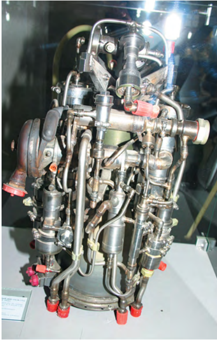
▲ Двигатель коррекции и сближения С5.62 для корабля ТКС и криогенный ЖРД 11Д122 ракеты-носителя «Энергия»
