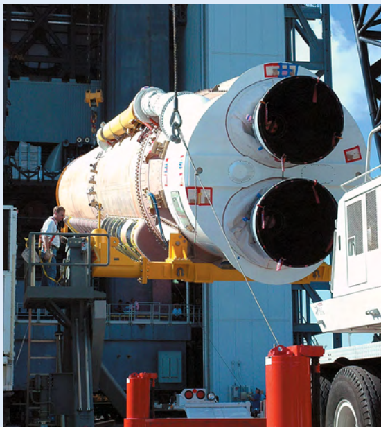
▼ Установка центрального блока с РД-180 на старт
