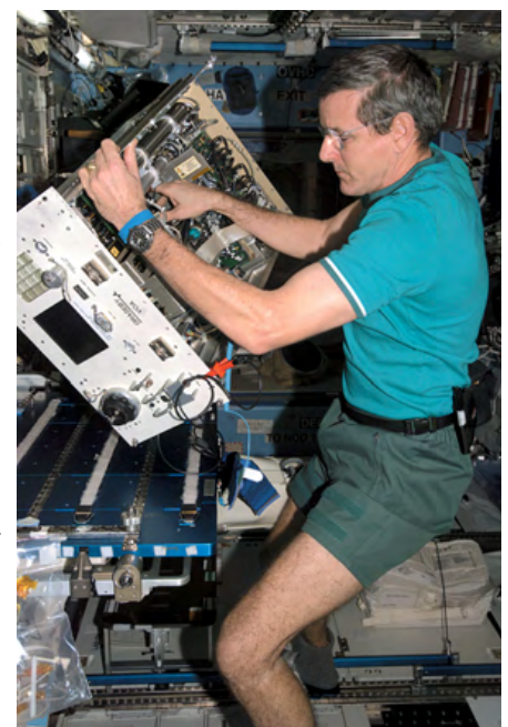
▲ Командир ремонтирует анализатор летучих соединений VOA
