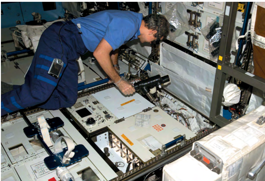
▲ МакАртур готовится к замене вентиляторов блока AAA стойки SHeCS
