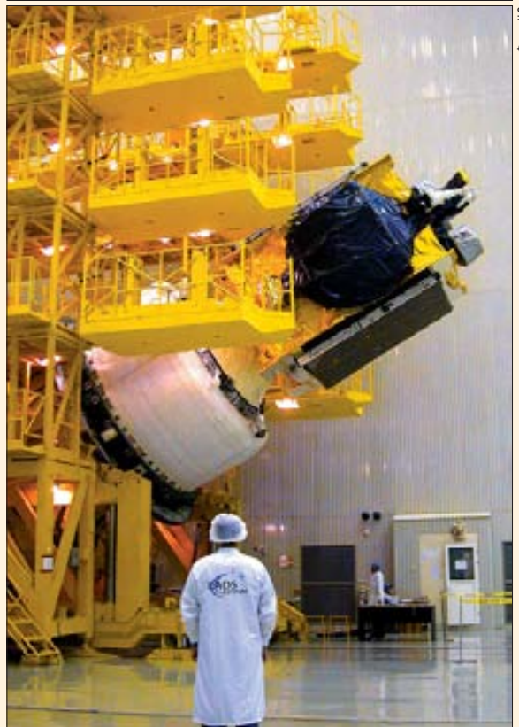
КА Anik F1R состыкован с разгонным блоком «Бриз-М»
