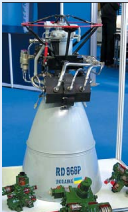
Ракетный двигатель РД-868Р (он же РД-869) для 4-й ступени европейской РН Vega
