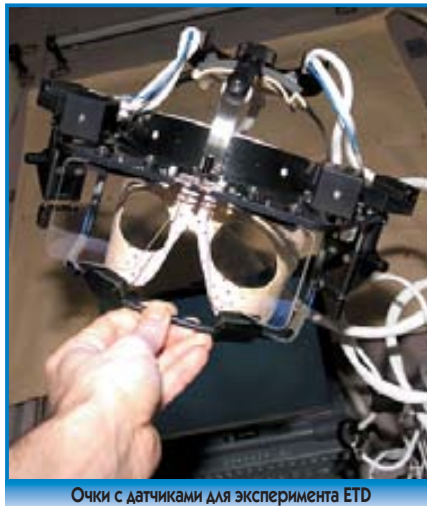
Очки с датчиками для эксперимента ETD
